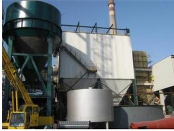
该产品采用侧部扩散多元进风均流技术、有效柔性清灰技术、大风量提升阀、大容量分气箱、双层密封提升阀等技术。具有除尘效率高，设备占地面积小，钢耗省，运行稳定和维护管理方便等特点。有效解决了气流流场分布和再分配、大流量除尘与脉冲清灰、高浓度粉尘去除和降低运行阻力、过滤风速选取和除尘效率等关键问题。可广泛应用于电力、冶金、建材等行业的烟气除尘治理。
